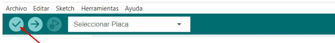
**PASO 6.** Conecte el cable del Arduino a este y al puerto USB de su computadora.**PASO 7.** Cargue el programa
