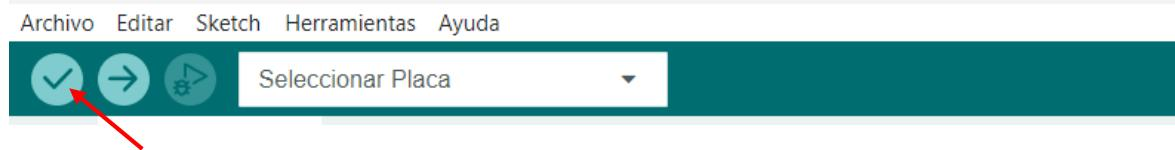
**PASO 6.** Conecte el cable del Arduino a este y al puerto USB de su computadora.**PASO 7.** Cargue el programa
